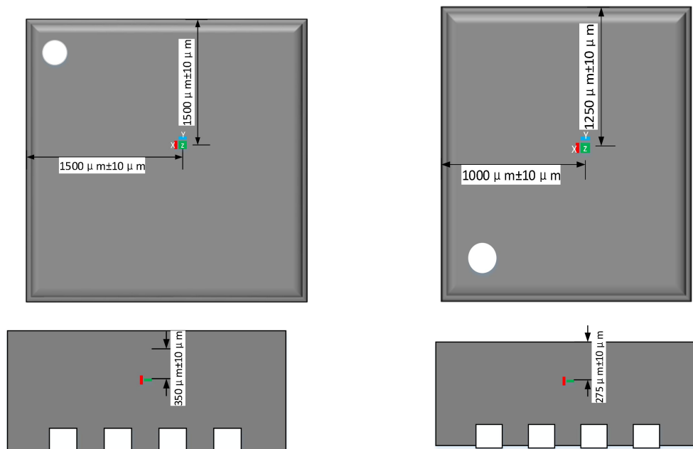
图 7-2. 各轴 Hall 元件在封装内的相对位置
